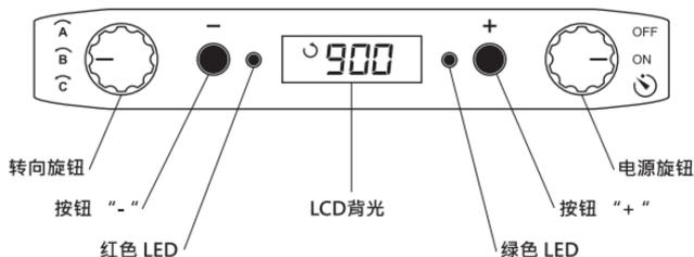
**转动:** 按下黑色 “+” 或 “-” 按钮，可以增加或减少每天腕表上链旋转的次数。每一档 “上” 或 “下” 的变化为50转。单日旋转次数最低设定为300次，最高1200次。LCD显示屏会显示装置当前的设置状态。装置预设每天900转。
