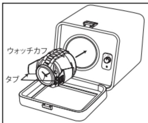
**手順 2 -** アダプターが接続してある、または、電池が入っている状態でつまみを必要な回転位置まで回します。「A」は時計回り、「B」は反時計回り、そして「C」はその両方となっています。回転サイクルプログラムは回転設定を選択してから 10 秒後に作動します。
