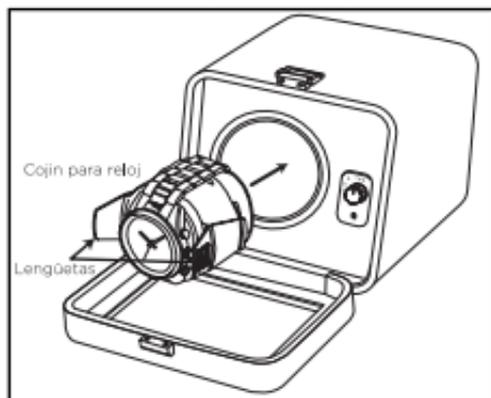
**Paso 2 -** Con el adaptador conectado, gire la perilla a la posición de rotación requerida. "A" para girar a la derecha, "B" para girar a la izquierda, o "C" para una combinación de ambos. El programa de ciclo de rotación se iniciará 10 segundos después de haber seleccionado un ajuste de rotación.
